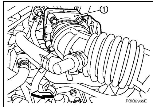
3. 使用诊断仪或测试仪，测量电子节气门控制执行器端口 1 与接地之间的电压。
